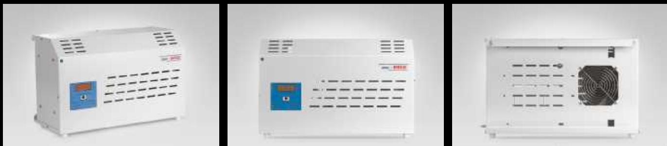
Конструктивно нормализаторы данного класса выполнены в металлических корпусах прямоугольной формы. На передней панели расположен цифровой светодиодный индикатор, отображающий значения основных параметров режима работы прибора (входное и выходное напряжение, мощность нагрузки, аварийные режимы работы) и кнопка выбора отображаемого параметра. Расцепитель независимой защиты от перенапряжения, переключатель «Стабилизация- Транзит», контрольная розетка выходного напряжения в данной серии отсутствуют.
